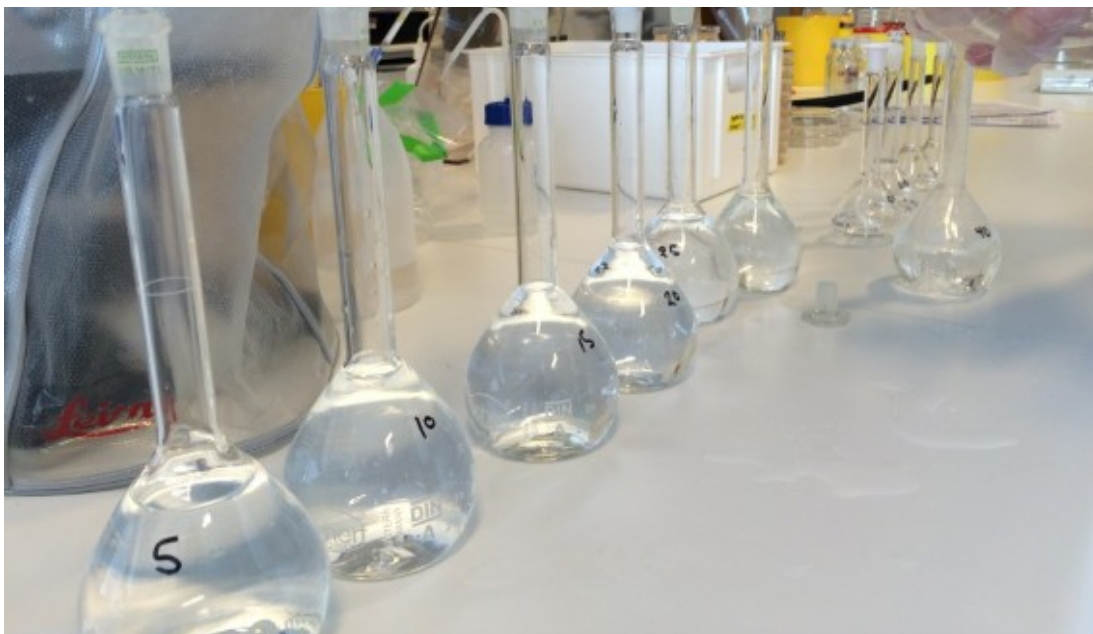
Figur 1. Opsætning af standardrække for test af nitratmåleudstyr omkring en standardkurve. Fotos af Camilla Vestergaard, SEGES
